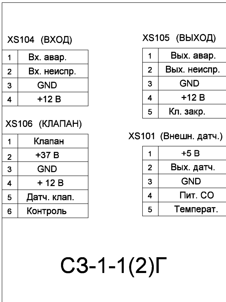
Рисунок Б - Схема внешних соединений сигнализатора
