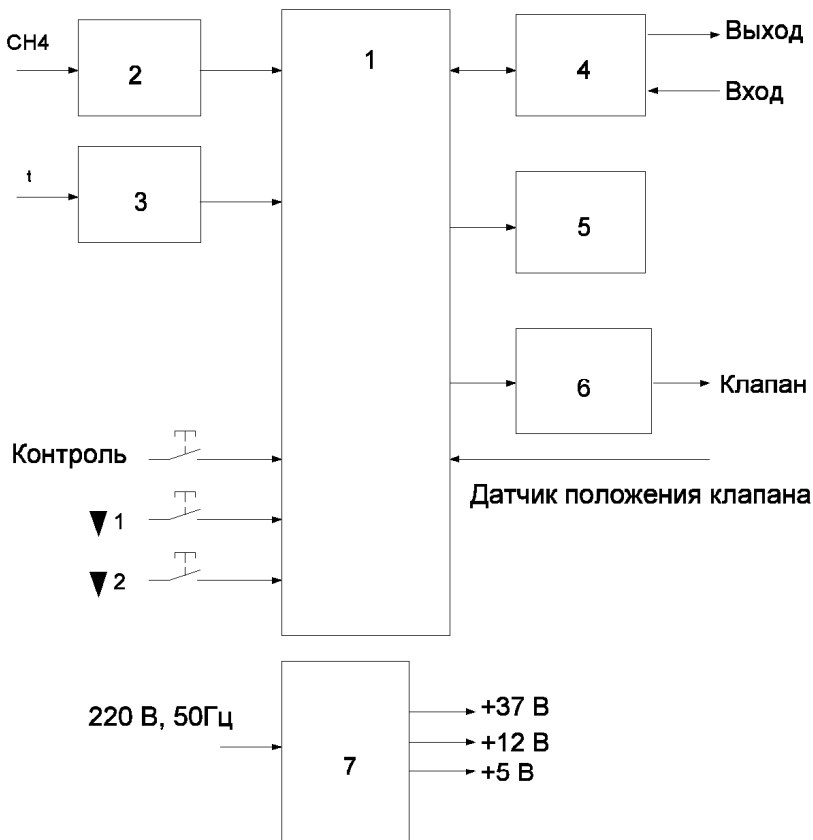
Схема структурная сигнализатора
