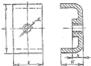
Гайки закладные предназначены для крепления аппаратов, кабелей, проводов и труб к С-образным профилям.
