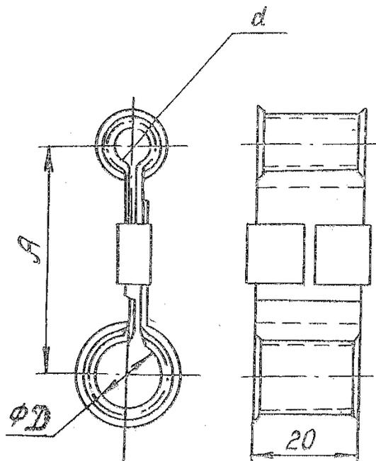
Подвесы кабельные серии П предназначены для подвески телефонного кабеля к стальному тросу.
