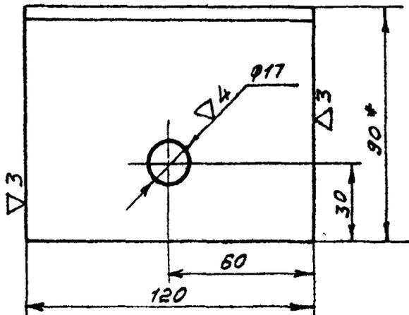
Уголок наравнополочный 90x56x6 ТК4-3217-71 применяется для закрепления кронштейна подвешенного КТП ТК4-3237-81 на металлической двутавровой балке при прокладке трассы в металлических коробах.
