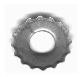
Шайба заземляющая ТУ 36.22.21.001-86 с внутренним отверстием Ø 8,5 мм, предназначена для создания металлической связи между соединенными болтовым соединением окрашенными деталями.
