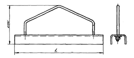
Предназначены для прокладки трасс из коробов СП и лотков ЛП, ЛМТ, K420 на кронштейнах серии К второго исполнения с креплением трассы к плитам перекрытий с помощью перфополосы, проволоки или троса при монтаже систем энергоснабжения и АСУ ТП.
