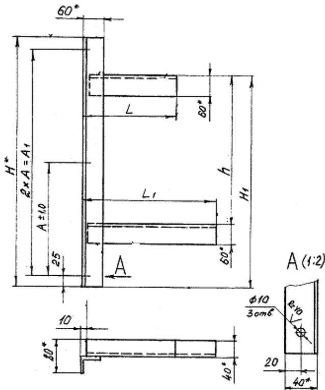
Применяются для двухрядной прокладки горизонтальных участков кабельных трасс в стальных коробах систем энергоснабжения.
