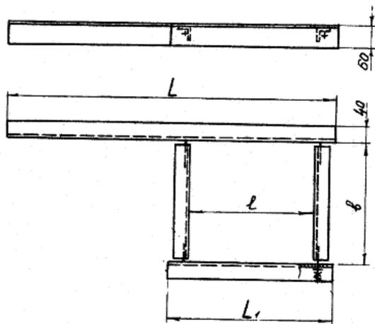
Применяются в подвесных системах для установки стальных коробов в системах АСУ ТП.
