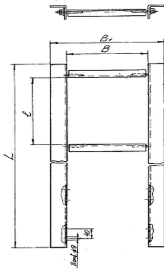
Применяются в подвесных системах для установки лотков ЛМТ, ЛМТК, мостов МШ в системах АСУ ТП.
