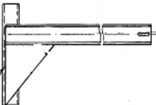
Применяются для установки кабельных лотков и шинных мостов в системах АСУ ТП.
