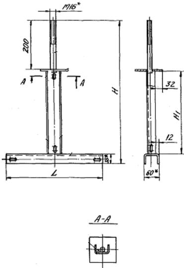
Кронштейн подвесной КТП предназначен для крепления двух идущих параллельно кабельных трасс, проложенных в лотках и коробах к перекрытиям и другим строительным конструкциям
