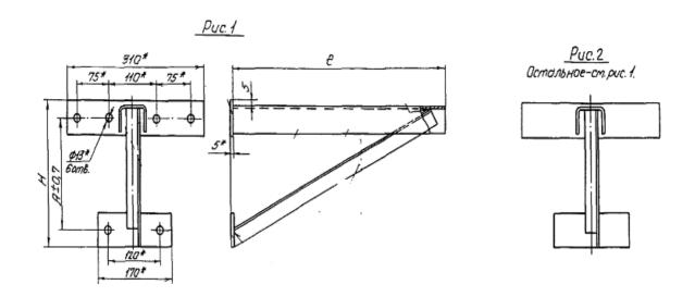
Кронштейн КТ предназначен для крепления многорядной кабельной трассы, проложенных в лотках и коробах к стенам и другим строительным конструкциям
